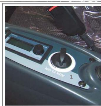
Diese Einstellung wird sowohl in Modalität des einfachen Effekts (Fluss der linken Leitung) als auch in der Modalität des doppelten Effekts (Fluss in beiden Leitungen) angewendet.
