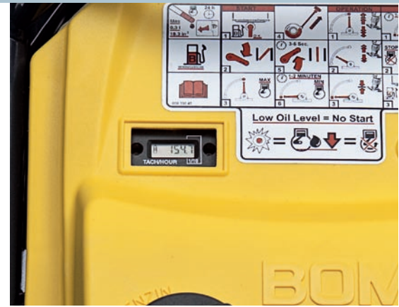
Stunden- und Drehzahlmesser mit Service-Anzeige für optimale Wartungsplanung.
