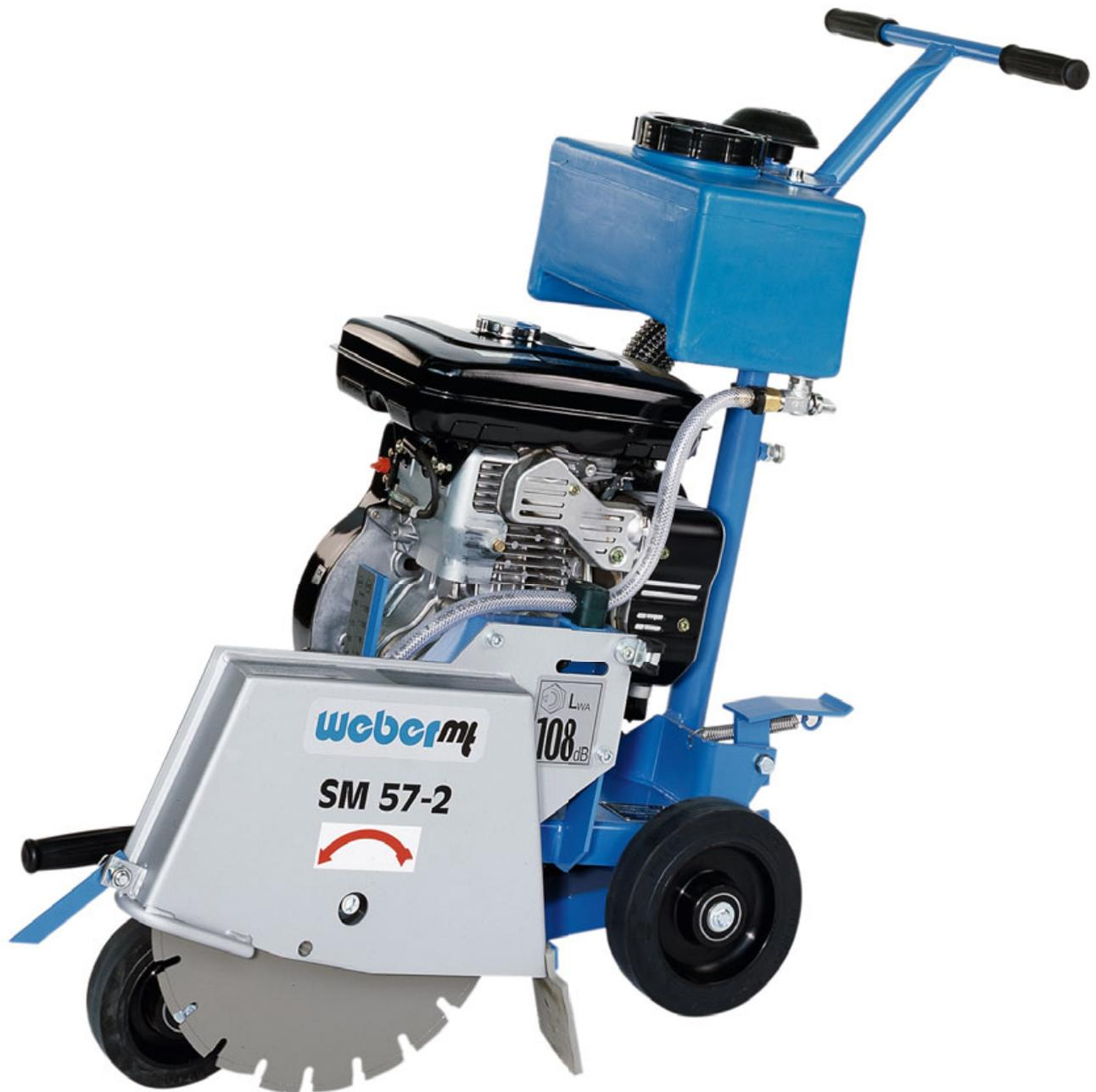
Die kompakten und robusten Fugenschneider der Baureihe SM 57-2 sind die idealen Helfer für alltägliche Schneidarbeiten. Dank leistungsstarker Motoren ermöglichen sie eine Schneidtiefe von bis zu 120 mm und sorgen damit für schnelle und somit wirtschaftliche Arbeitsabläufe.
